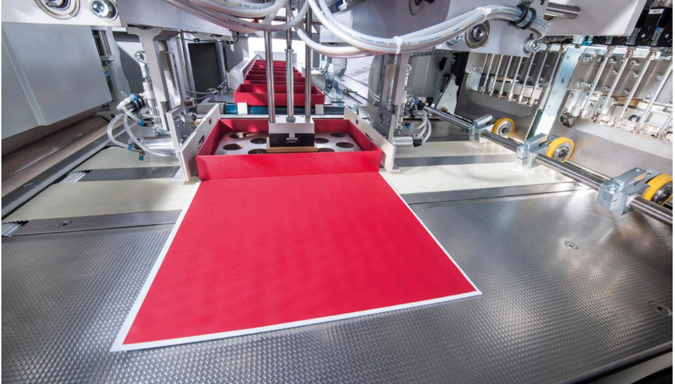
Aufsetzmodul für Schachteln, Typ Box Placer BP 500 – Aufsetzen von flachen Stanzzuschnitten, Modul CP 500
