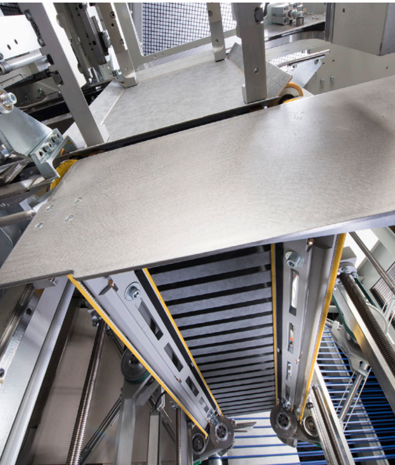
Box Line Former BLF 500, Aufricht- und Formstation
